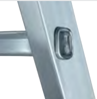
Jonction barreaux-montants sertie 4 fois
